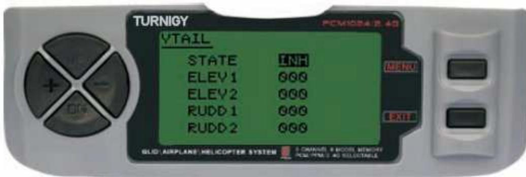
Da Impostazioni FUNC, premere il tasto MENU. Poi con i tasti UP / DOWN selezionare la funzione VTAIL e premere MENU per entrare. Poi, con i tasti + / - selezionare INH o ACT per attivare questa funzione o disattivare. Una volta fatto, ancora una volta con i tasti + / - assegnare la rettifica di valore desiderato per ascensori e timone (es). Premere MENU per salvare le modifiche e tornare al menu precedente o EXIT per annullare e uscire.
