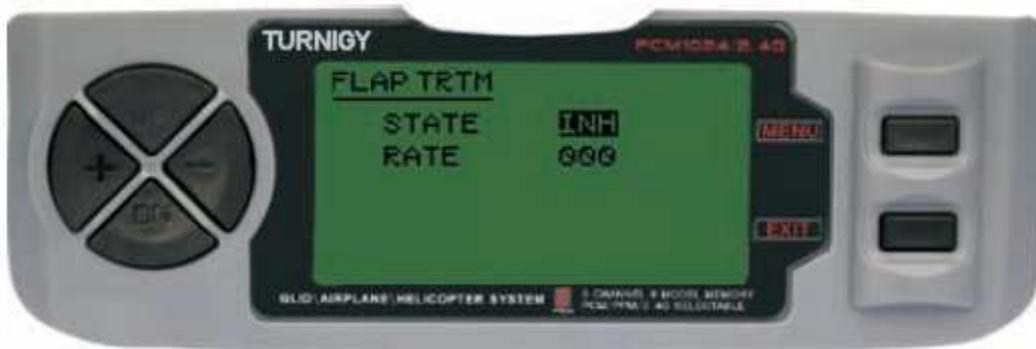
Da Impostazioni FUNC, premere il tasto MENU. Poi con i tasti UP / DOWN selezionare la funzione TRIM FLAP e premere MENU per entrare. Poi, con i tasti + / - selezionare INH o ACT per attivare questa funzione o disattivare. Una volta fatto, ancora una volta con i tasti + / - assegnare il valore desiderato per tale adeguamento controllo. Premere MENU per salvare le modifiche e tornare al menu precedente o EXIT per annullare e uscire.
