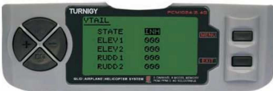
Da Impostazioni FUNC, premere il tasto MENU. Poi con i tasti UP / DOWN selezionare la funzione VTAIL e premere MENU per entrare. Poi, con i tasti + / - selezionare INH o ACT per attivare questa funzione o disattivare. Una volta fatto, ancora una volta con i tasti + / - assegnare la rettificata di valore desiderato per ascensori e timone (s). Premere MENU per salvare le modifiche e tornare al menu precedente o EXIT per annullare e uscire.
