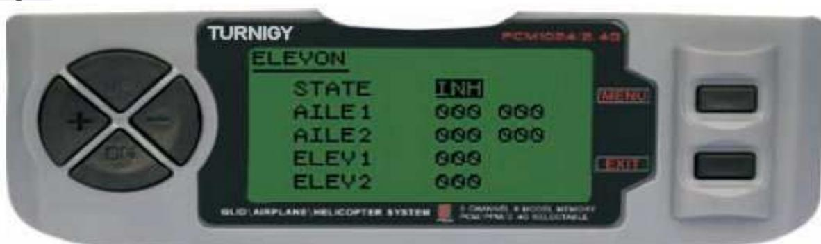
Da Impostazioni FUNC, premere il tasto MENU. Poi, usando la funzione UP / DOWN selezionare elevon e premere MENU per entrare. Poi, con i tasti + / - selezionare INH o ACT per attivare questa funzione o disattivare. Una volta fatto, ancora una volta con i tasti + / - assegnare la rettifica di valore desiderato per Roll e Nick (s). Premere MENU per salvare le modifiche e tornare al menu precedente o EXIT per annullare e uscire.
