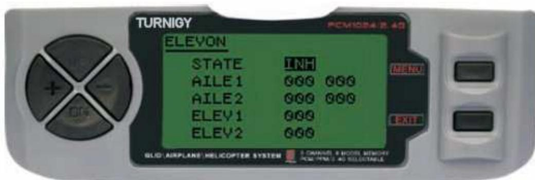
Da Impostazioni FUNC, premere il tasto MENU. Poi, usando la funzione UP / DOWN selezionare elevon e premere MENU per entrare. Poi, con i tasti + / - selezionare INH o ACT per attivare questa funzione o disattivare. Una volta fatto, ancora una volta con i tasti + / - assegnare la rettificazione di valore desiderato per Roll e Nick (s). Premere MENU per salvare le modifiche e tornare al menu precedente o EXIT per annullare e uscire.
