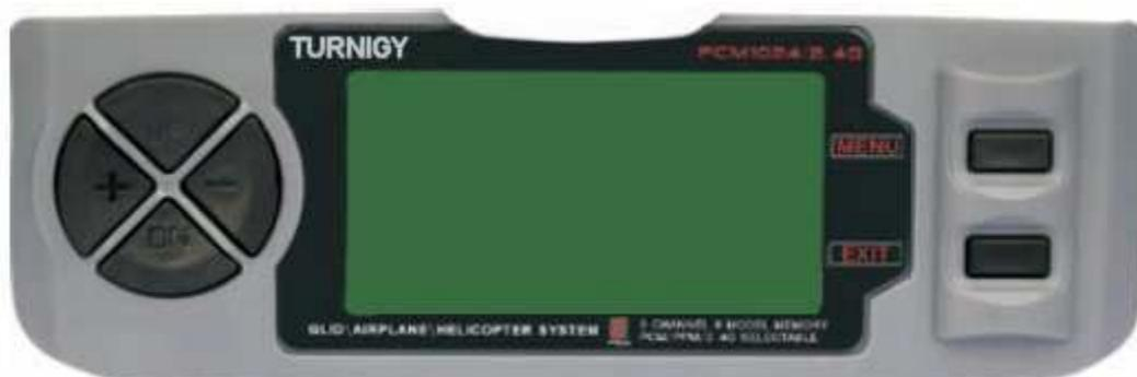
Da Impostazioni FUNC, premere il tasto MENU. Poi con i tasti UP / DOWN selezionare la funzione E.POINT e premere MENU per entrare. Poi di nuovo con i tasti UP / DOWN selezionare il canale che si desidera regolare. Ora, con i tasti + / - per regolare il limite di corsa del servo per questo canale. Una volta fatto, premere MENU per salvare la nuova posizione e tornare al menu precedente. In alternativa, premere EXIT per uscire dal menu senza salvare le modifiche.
