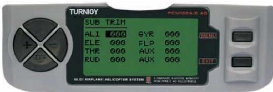
Questa funzione consente di regolare elettronicamente correggere centratura di ogni servo. Ogni Sub-Trim è regolabile individualmente e gli 8 canali può variare dal 120% al 120% di correzione.
