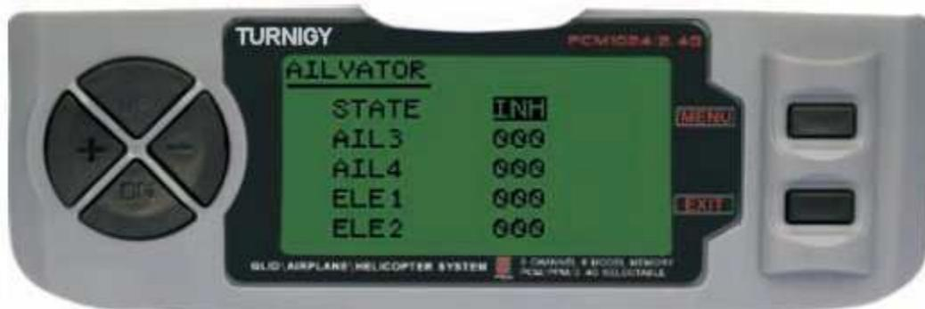
Da Impostazioni FUNC, premere il tasto MENU. Poi, usando la funzione UP / DOWN selezionare AILVATOR e premere MENU per entrare. Poi, con i tasti + / - selezionare INH o ACT per attivare questa funzione o disattivare. Una volta fatto, ancora una volta con i tasti + / - assegnare il rettifica di valore desiderato per ogni alettone ed elevatore. Premere MENU per salvare le modifiche e tornare al menu precedente o EXIT per annullare e uscire.
