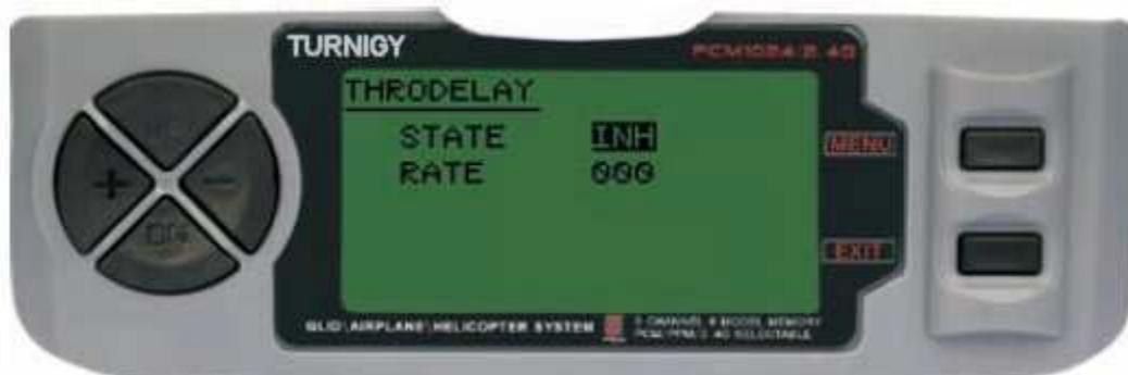
Questa funzione può essere applicata a comando servo altri (per esempio alle porte di un carrello retrattile) che la collega al canale 3, e l'acceleratore in un canale ausiliario (canale 8 per esempio) e rendendo la miscela corrispondente.
