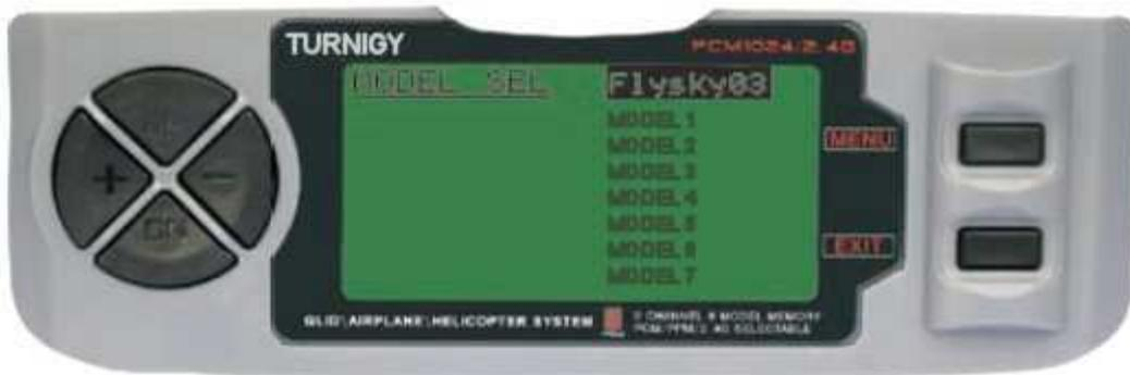
Dal menu Impostazioni di sistema, selezionare SELE MODELLO, quindi premere il tasto MENU. Qui (e anche utilizzando i tasti UP / DOWN) MODULANTE e scegliere l'opzione con i tasti UP / DOWN selezionare il tipo di modulazione desiderato per quel modello. Poi confermare la scelta premendo il tasto MENU. Quindi premere il tasto EXIT per tornare al menu precedente.
