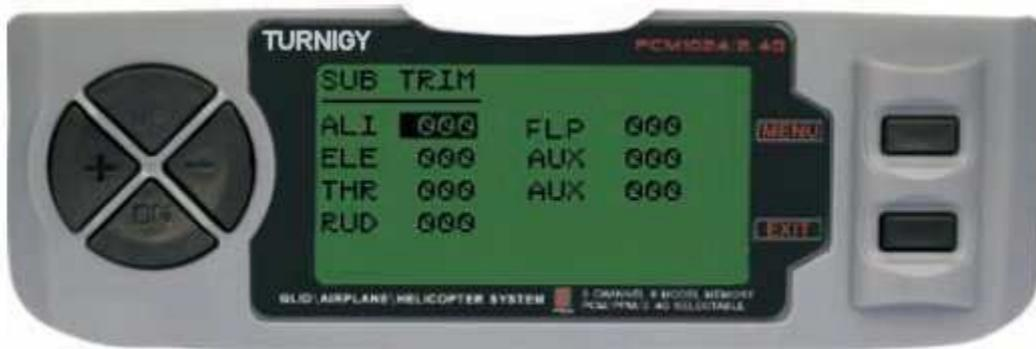
Da Impostazioni FUNC, premere il tasto MENU. Poi con i tasti UP / DOWN selezionare il sub-trim e premere MENU per entrare. Poi di nuovo con i tasti UP / DOWN selezionare il canale che si desidera regolare. Ora, con i tasti + / - impostare la posizione del servo di quel canale. Una volta fatto, premere MENU per salvare la nuova posizione e tornare al menu precedente. In alternativa, premere EXIT per uscire dal menu senza salvare le modifiche.
