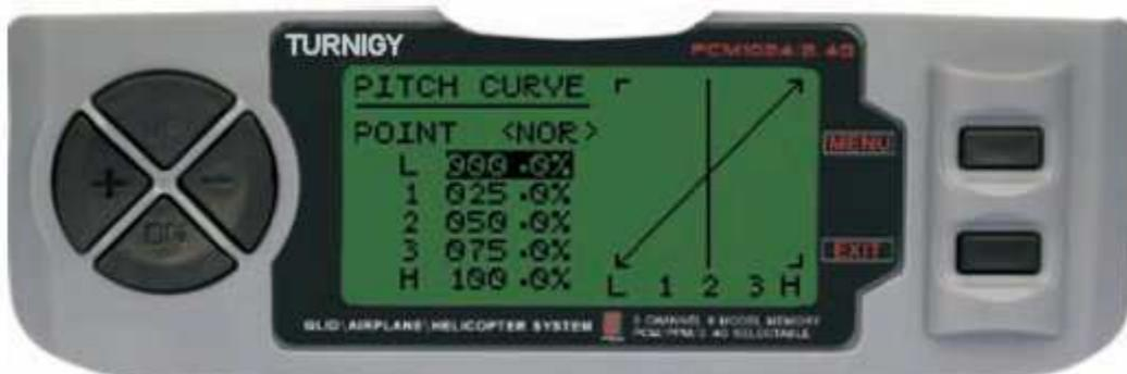
Da Impostazioni FUNC, premere il tasto MENU. Poi con i tasti UP / DOWN selezionare la funzione PITCH CURVE e premere MENU per entrare. Poi di nuovo con i tasti UP / DOWN selezionare la curva che si desidera impostare / modificare. Ora, con i tasti + / - valore del passo di regolazione conveniente in quel punto. Una volta fatto, premere MENU per salvare la nuova impostazione e tornare al menu
