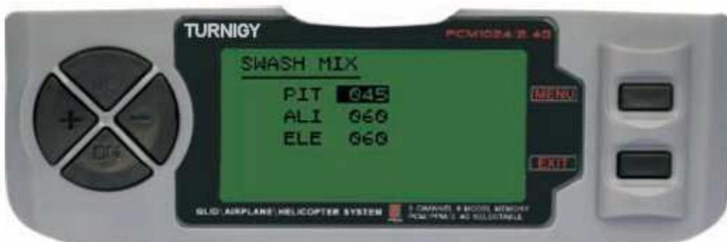
Da Impostazioni FUNC, premere il tasto MENU. Poi con i tasti UP / DOWN selezionare la funzione SWASH MIX e premere MENU per entrare. Poi di nuovo con i tasti UP / DOWN selezionare il controllo che si desidera regolare. Ora, con i tasti + / - per regolare il mix. Una volta fatto, premere MENU per salvare e tornare al menu precedente. In alternativa, premere EXIT per uscire dal menu senza salvare le modifiche.
