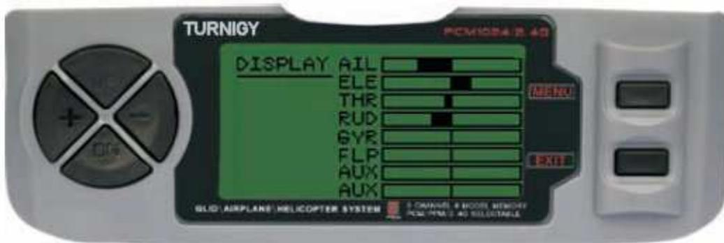
Da Impostazioni FUNC, premere il tasto MENU. Poi, usando la funzione UP / DOWN selezionare DISPLAY, premere MENU per entrare. Poi di nuovo con i tasti UP / DOWN selezionare ON / OFF per attivare o disattivare la verifica. Una volta fatto, premere MENU per tornare al menu precedente e Esci per uscire.
