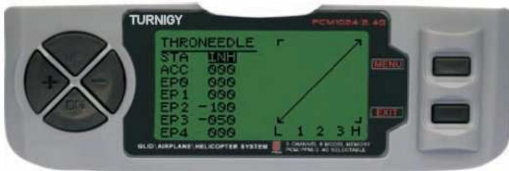
Da Impostazioni FUNC, premere il tasto MENU. Poi con i tasti UP / DOWN selezionare la funzione THRONEEDLE e premere MENU per entrare. Poi, con i tasti + / - selezionare INH o ACT per attivare questa funzione o disattivare. Una volta fatto, ancora una volta con i tasti + / - assegnare i parametri di regolazione del valore desiderato mix desiderato .. Premere MENU per salvare le modifiche e tornare al menu precedente o EXIT per annullare e uscire.
