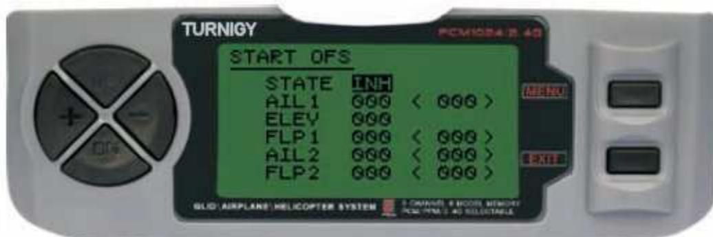
Da Impostazioni FUNC, premere il tasto MENU. Poi, usando la funzione UP / DOWN selezionare STARTOFS e premere MENU per entrare. Poi, con i tasti + / - selezionare INH o ACT per attivare questa funzione o disattivare. Una volta fatto, ancora una volta con i tasti + / - assegnare la rettifica di valore desiderato per alettoni, elevatore e flaps. Premere MENU per salvare le modifiche e tornare al menu precedente o EXIT per annullare e uscire.
