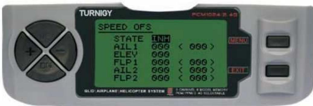
Da Impostazioni FUNC, premere il tasto MENU. Poi, usando la funzione UP / DOWN selezionare SPEEDOFS e premere MENU per entrare. Poi, con i tasti + / - selezionare INH o ACT per attivare questa funzione o disattivare. Una volta fatto, ancora una volta con i tasti + / - assegnare la rettifica di valore desiderato per alettoni, elevatore e flaps. Premere MENU per salvare le modifiche e tornare al menu precedente o EXIT per annullare e uscire.
