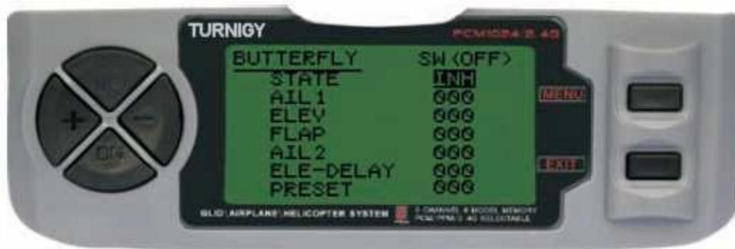
Da Impostazioni FUNC, premere il tasto MENU. Poi, usando la funzione UP / DOWN selezionare BUTTERFLY e premere MENU per entrare. Poi, con i tasti + / - selezionare INH o ACT per attivare questa funzione o disattivare. Una volta fatto, ancora una volta con i tasti + / - assegnare la rettifica di valore desiderato per Aileron, Elevator, Flaps, timone e un ritardo per l'ascensore (se necessario). Premere MENU per salvare le modifiche e tornare al menu precedente o EXIT per annullare e uscire.
