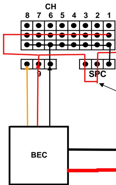
La ricevente e i servi vengono alimentati dal BEC. Sul TX si legge la tensione in uscita dal BEC.
