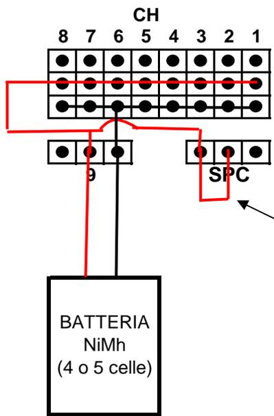
La ricevente e i servi vengono alimentati dalla batteria NiMh. Sul TX si legge la tensione del pacco NiMh.
