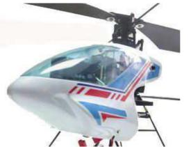
**6.** Installate la capottina infilando le due asole sulla struttura del carrello anteriore e premete sugli anelli in gomma attaccati alla bara di montaggio orizzontale.
