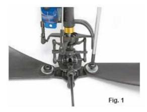
**1.** Fissate le pale del rotore al supporto delle pale. Utilizzando le viti e le rondelle in dotazione fissate le pale con fermezza in modo che non si muovano. Non serrate troppo!
