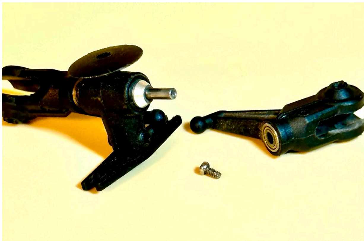
TESTA CON SPINDLE SPORGENTE, IL PORTA-PALE STACCATO E LA VITE DI BLOCCAGGIO. (SI NOTI LA POSIZIONE DELLA RONDELLA CONICA) (DIAMETRO ASSE 1.5MM)
