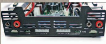
Alle Anschlüsse für Kanal 1 und 2 befinden sich auf der Vorderseite des Power Peak Twin 1000W.
