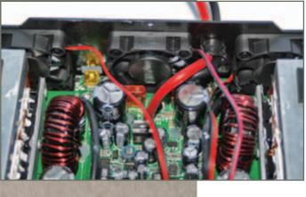
Die drei Lüfter an der Gehäuserückseite arbeiten leise und sehr effektiv. Auch bei hoher Ladeleistung bleibt die Elektronik kühl.
