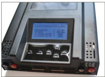
Die Bedienung des Power Peak Twin 1000W erfolgt über sechs Folientasten. Das Display ist zweigeteilt für die Darstellung der Parameter von Kanal 1 und 2.
