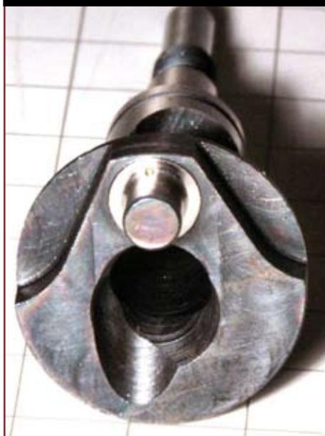
Classico anch'esso, da 13mm di diametro e foro da 9mm che termina con una piccola "virgola".
