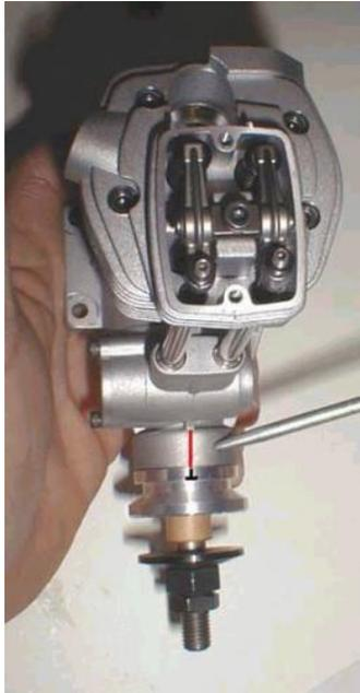
Durante il movimento dell'albero motore, noterete che le valvole si aprono e si chiudono alternativamente, al giro seguente noterete che con il pistone al PMS le valvole restano immobili in posizione di riposo...immobilizzate l'albero motore in questa posizione precisa.
