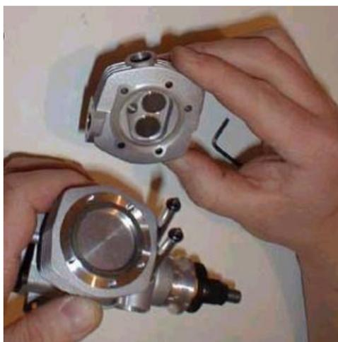
Adesso si possono smontare le cinque brugole della testata (notate sul block notes lunghezza diametro e disposizione delle brugole via via che le smontate), smontate la medesima facendo attenzione alle o-ring dei foderi delle aste che nel caso di un motore usato possono risultare incollate alla testata, fate attenzione inoltre alla guarnizione della testata una sottile rondella di alluminio.
