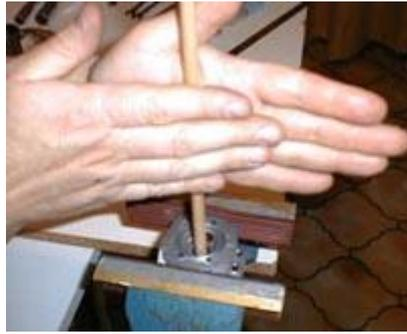
Fate ruotare il tondino tra le palme delle mani esercitando contemporaneamente una leggera pressione sulla valvola (verso la sede) ed effettuate due o tre “va e vieni”. Dovete “sentire” l’abrasione della portata della valvola sulla sede. Sollevate leggermente la valvola, ruotatela di  $\frac{1}{4}$  di giro e ricominciate, ripetete la procedura tre o quattro volte (sollevare e  $\frac{1}{4}$  di giro ogni volta).
