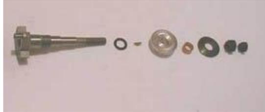
Adesso spingete l'albero motore in direzione del tappo posteriore in modo da sfilarlo...
