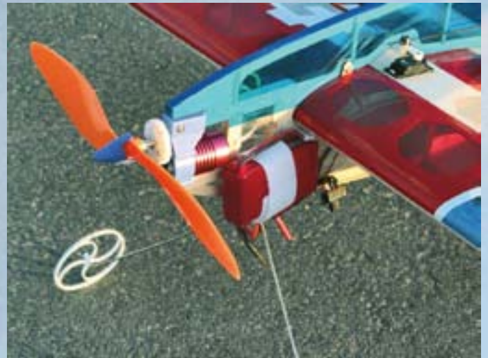
Die Antriebseinheit ist auf einem Stab befestigt, direkt daneben ist der Akku montiert
