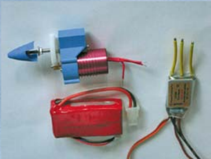
Ein Brushlessgetriebemotor, ein 3S1P LiPo und ein Regler sind im Combo-Set enthalten
