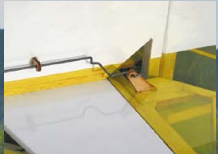
Damit die Ruderanlenkung sauber und leicht durch die Holzösen läuft, muss sie am Ruder sorgfältig gebogen werden
