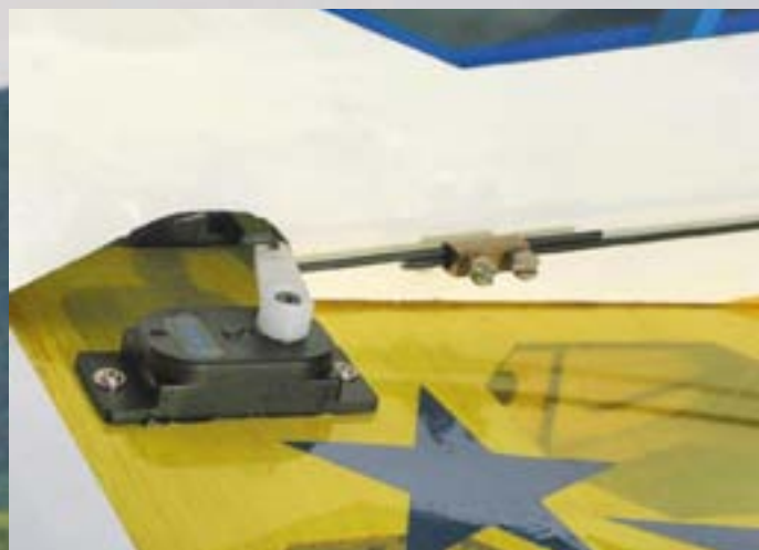
Die Ruderanlenkungen sind in Eigeninitiative längenverstellbar gemacht worden
