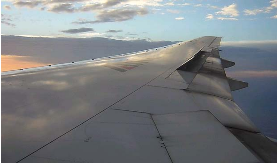
Utilizzo degli air-brakes (spoilers) in discesa.
