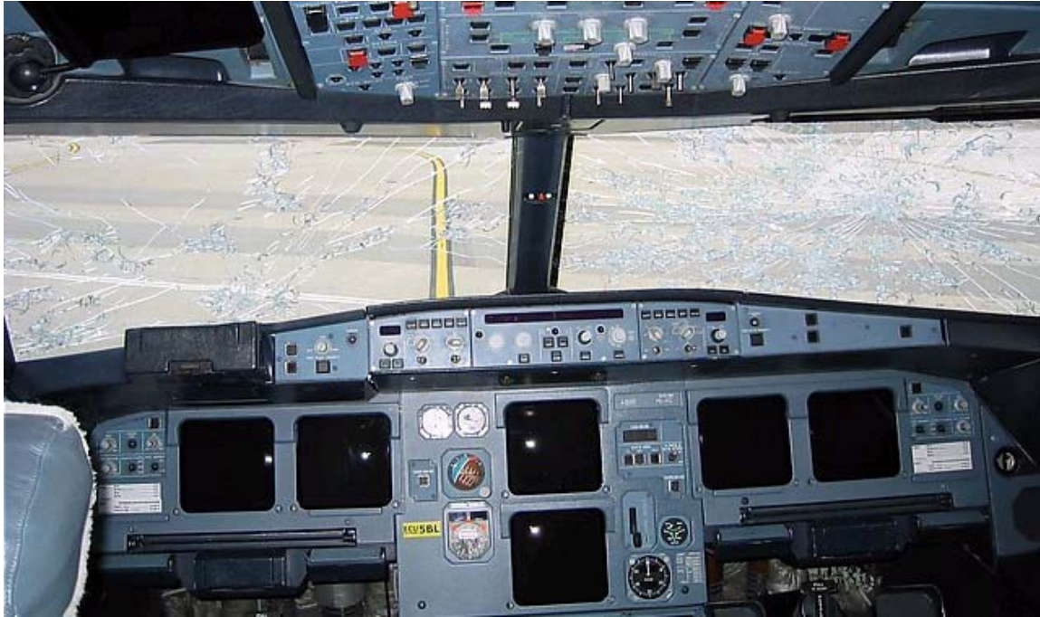
Effetti di una grandinata sul parabrezza di un Airbus
