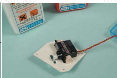
Servo mit Epoxy auf die Abdeckung Ansicht von der anderen Seite kleben
