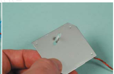
Servo mit Epoxy auf die Abdeckung Ansicht von der anderen Seite kleben
