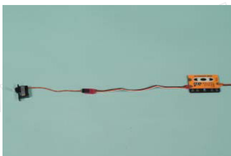
Servo in Mittelstellung bringen
