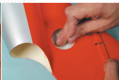
Anschleifen zur besseren Verklebung
