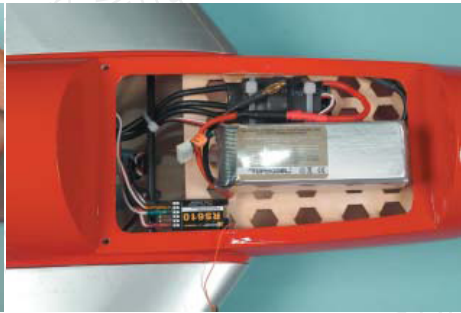
Empfänger und Akku einbauen
