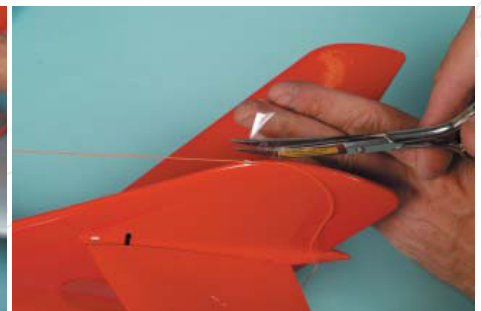
Antenne zum Seitenleitwerk spannen
