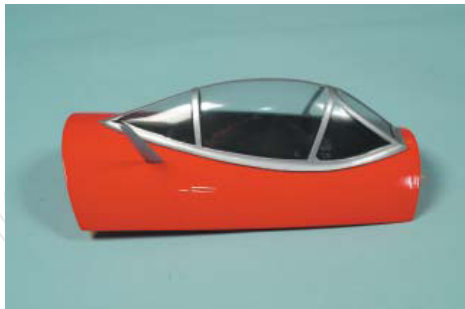
Die fertige Kabinenhaube
