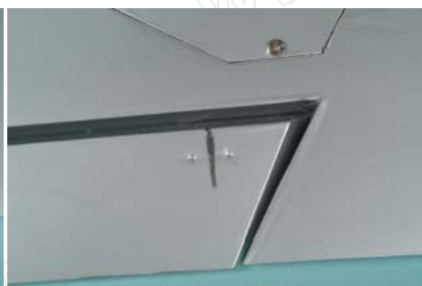
Ausschnitt für Ruderhorn fertigen
