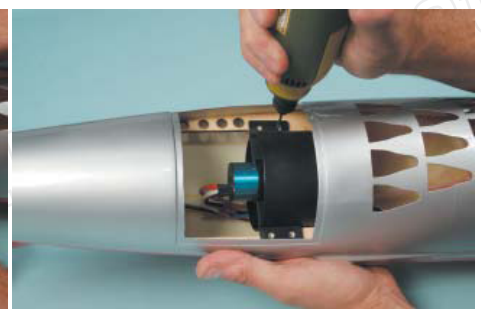
Impeller positionieren und Befesti- gungslöcher bohren
