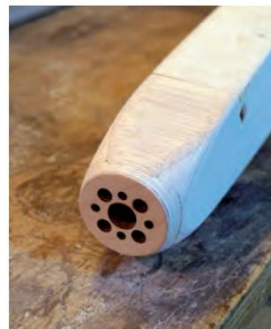
La costruzione inizia col montaggio della fusoliera, dei relativi portelli e della capottina. Dopo aver installato i bowden per i comandi di coda, si procede a rivestire il fondo e il dorso. La sagomatura del naso è l'ultima operazione prima della carteggiatura finale. Noi abbiamo optato per la versione elettrica che prevede un motore da 28 mm.
