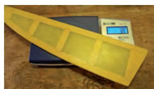
*In alto: il modello completo, pronto per essere rivestito. Nella sequenza qui a fianco, la tecnica di rivestimento in termoretraibile e carta. Si comincia a ricoprire il piano di coda e le fiancate aperte della fusoliera con l'Oracover Air e poi si passa alla carta. L'aumento di peso è irrilevante: solo un grammo di più per una parte mobile.*
