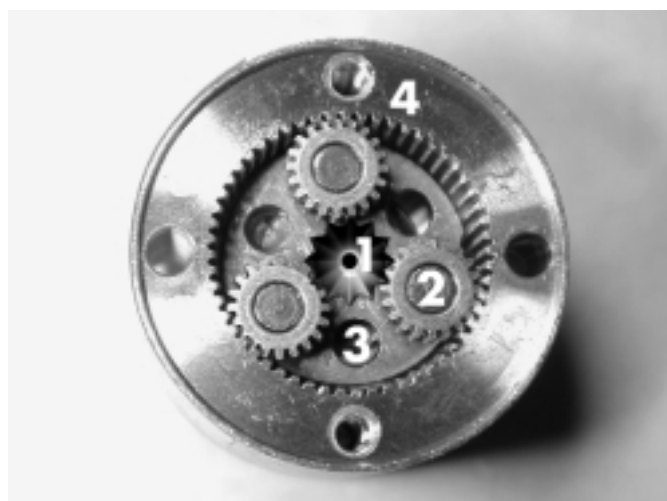
Un riduttore epicicloidale Cosmotech 4,5:1 ed una macro dello stesso, con gli elementi descritti nel testo. I Riduttori Cosmotech ed i Kruse sono reperibili da Schaller (055/284994), i G&G li ha Franco Garagnani (059/690250) mentre i riduttori Graupner li trovate nei migliori negozi.
