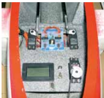
In basso: la centralina elettronica per la gestione delle batterie e dei servi costruita da Giorgio Somenzi e le installazioni di bordo, con la squadretta in Ergal (indicata dalla freccia) prodotta da Gigi Tibaldi (vedi testo per i dettagli).
