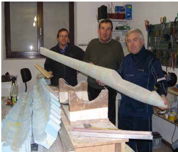
Le sezioni di fusoliera tagliate con la macchina CNC . A destra: Giorgio Somenzi, Beppe Ghisleri ed Elio Fornaciari col master pronto per la rifinitura. Sotto: lo stampaggio della fusoliera, le sezioni dell'ala e, finalmente, il prototipo preassemblato per vedere "l'effetto che fa".
