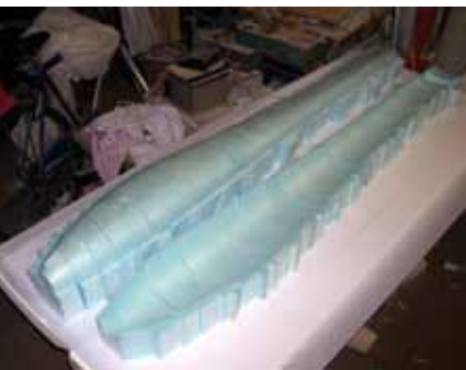
Le sezioni di fusoliera tagliate con la macchina CNC . A destra: Giorgio Somenzi, Beppe Ghisleri ed Elio Fornaciari col master pronto per la rifinitura. Sotto: lo stampaggio della fusoliera, le sezioni dell'ala e, finalmente, il prototipo preassemblato per vedere "l'effetto che fa".
