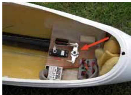
In basso: la centralina elettronica per la gestione delle batterie e dei servi costruita da Giorgio Somenzi e le installazioni di bordo, con la squadretta in Ergal (indicata dalla freccia) prodotta da Gigi Tibaldi (vedi testo per i dettagli).
