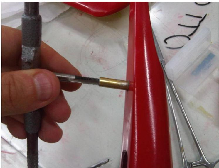
10. Abbiamo quasi finito, ora rimane da incollare una tavoletta di compensato con innesso un dato a griffa in corrispondenza del restante foro sulla fusoliera.
