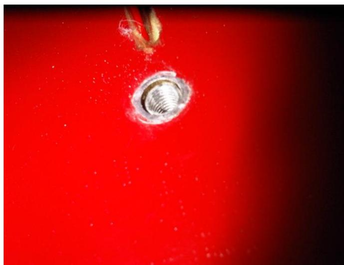
9. Stacciamo ora la fusoliera dall'ala e con una filiera , filettiamo l'interno del tondino, in maniera di poter ospitare una vite al nylon per il fissaggio dell'ala.
