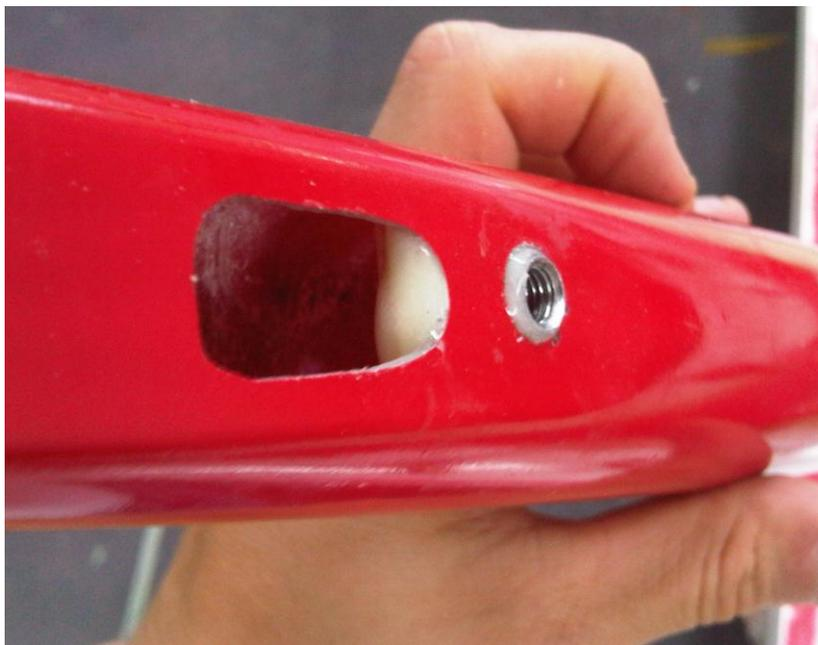
11. Abbiamo finito. In pratico abbiamo l'ala che si innesta alla fusoliera infilando il tondino posteriore che sporge dalla fusoliera, nell'ala. Per il fissaggio si applicheranno due viti al nylon, una sul dato a griffa , l'altra invece nel tondino d'ottone posteriore filettato in precedenza.
