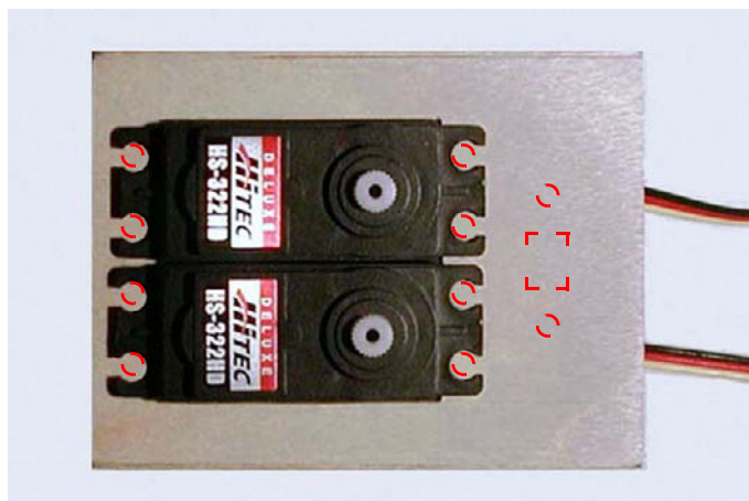
Fig.12:inserire i servocomandi nella basetta.
