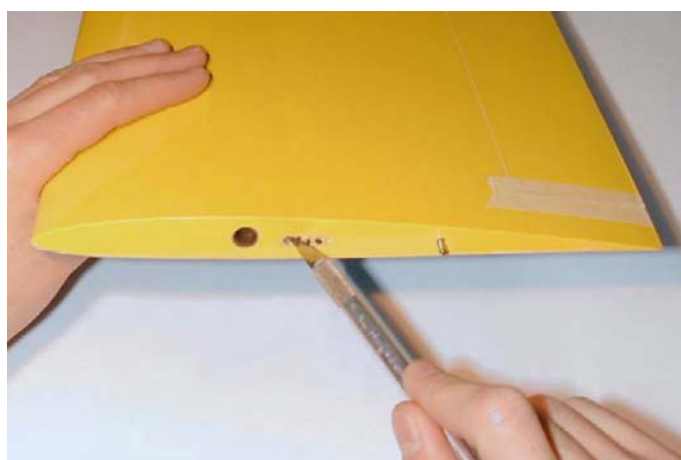
Fig.66: Asportare il materiale.
