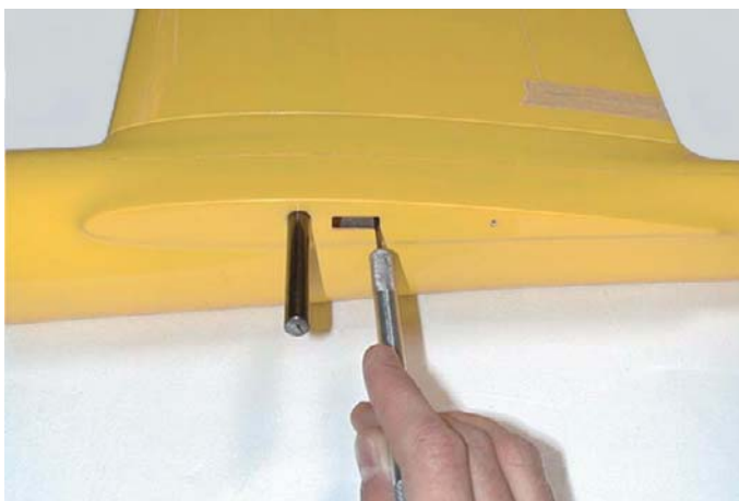
Fig.49:Riportare il contorno del foro sull'ala.
