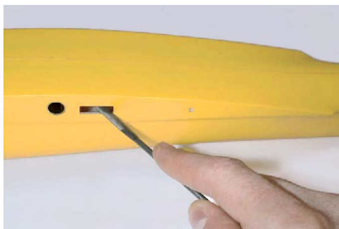
Fig.46: Rifinire la forma del foro.
