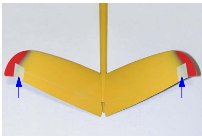
Fig.29:Tenere allineate le superfici mobili della coda.
