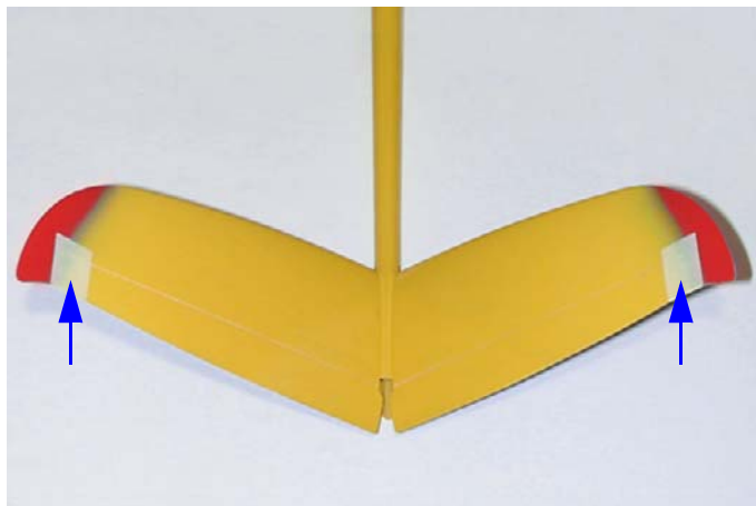
Fig.41: Tenere allineate le superfici mobili della coda.
