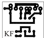
Regolatore di Velocità con freno per Mini Z
