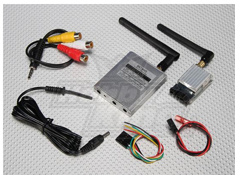
Il kit FPV di hobbyking, con ricevente (quella grossa) trasmettente, antenne stilo, caverteria varia.
